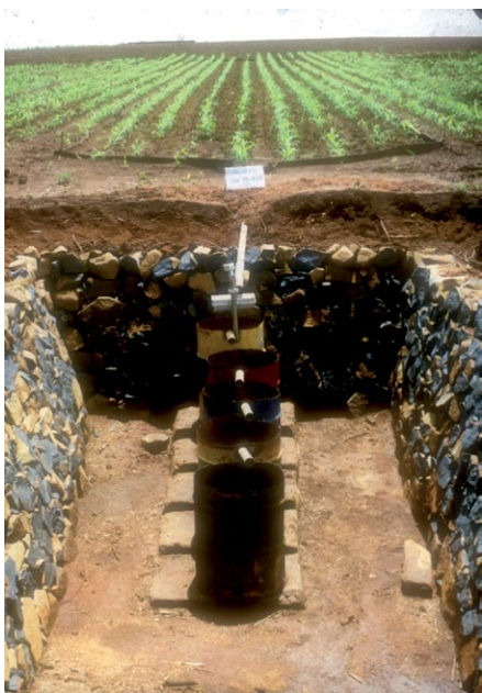
Stacionar s varijantom obrade u smjeru nagiba terena – erozijski nanos slijeva se na donji dio ograđene pokusne parcele, kroz cijev otječe do automatskog mjerača i prikuplja u prvu bačvu, a kada se ona napuni prelijeva se u sljedeću i tako redom.
