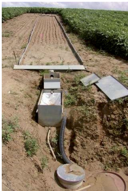
Izgled stacionara za mjerenje erozije u Daruvaru – Blagorodovac, erozijski nanos ograđene poznate površine prelazeći preko razdjelnika pada na filter koji zadržava erodirane čestice, a voda se skuplja u plastičnom kontejneru-bačvi.
