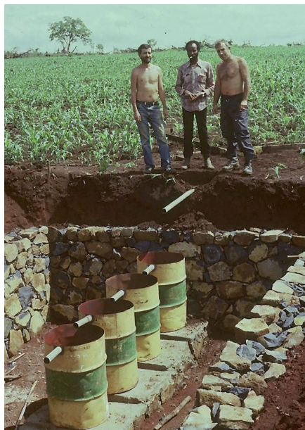
Stacionar za monitoring erozije na feralitičnom tlu Etiopije – poznata površina, ograđena i obrađivana niz padinu, okomito na pad i bez obrade – erozijski nanos prikuplja se u bačve
